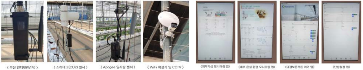
< 무선 인터넷(WiFi) > < 소하테크(CO2) 센서 > < Apogee 일사량 센서 > < WiFi 확장이 및 CCTV > < 외부기상 모니터링 앱 > < 내부 온실 환경 모니터링 앱 > < 다검보온커튼 제어 앱 > < 난방설정 앱 >
